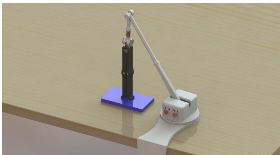
Figura 3.23: esempio di bloccaggio oggetti sul piano (Modo B): la pinza si appoggia sull'oggetto con le due estremità terminali, permettendo di
