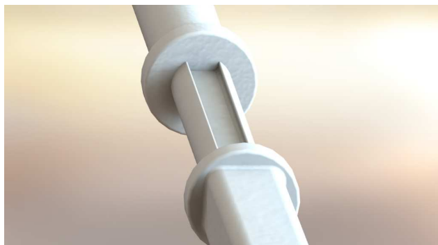
Figura 3.17: ingrandimento della coppia prismatica
