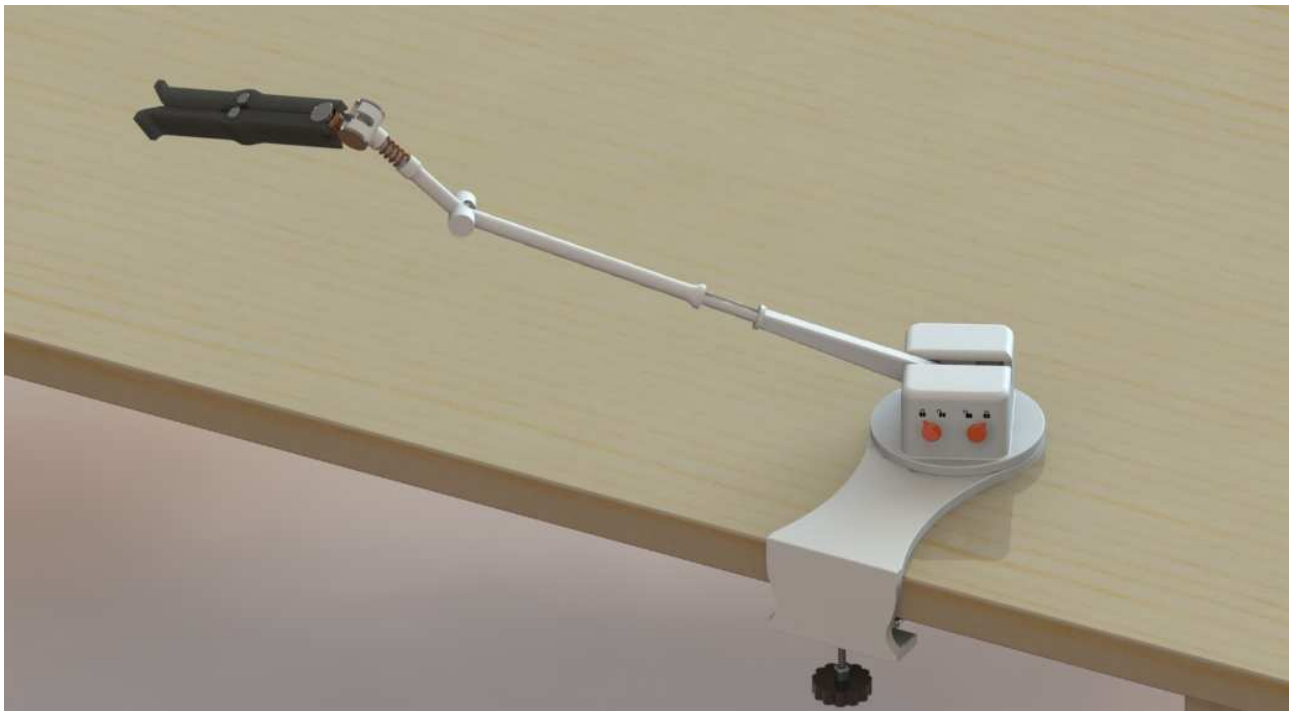
Figura 3.1: modello 3D dell'ausilio, qui rappresentato fissato ad un tavolo
