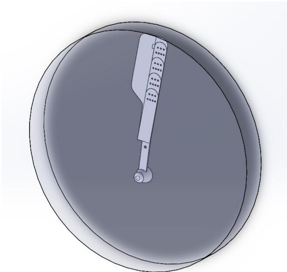
Figura 3.1.2: in grigio più scuro, il volume che viene fatto ruotare a vortice attorno alla pala.
