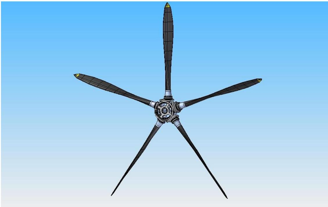
*Fig. 4.16 Elica 4,1 metri: montaggio gruppo pale*
