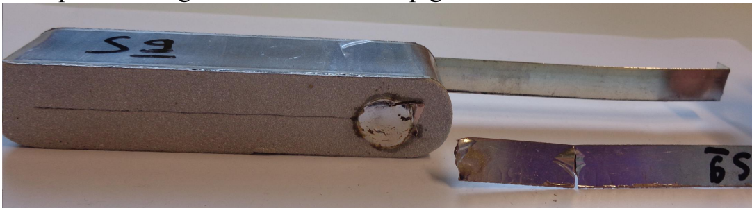
Figura 6.9 Dettaglio della rottura del provino 9.
