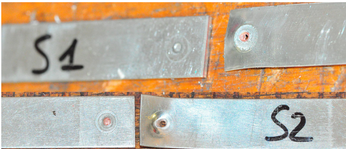
Figura 4.3 Dettaglio delle zone di rotture dei due provini.
