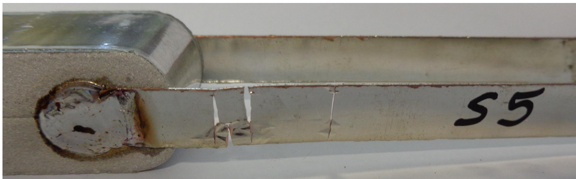
Figura 6.5 Dettaglio della rottura del provino 5.
