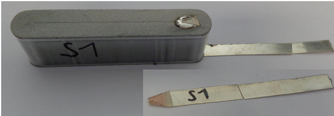
Figura 6.1 Dettaglio della rottura del provino 1.
