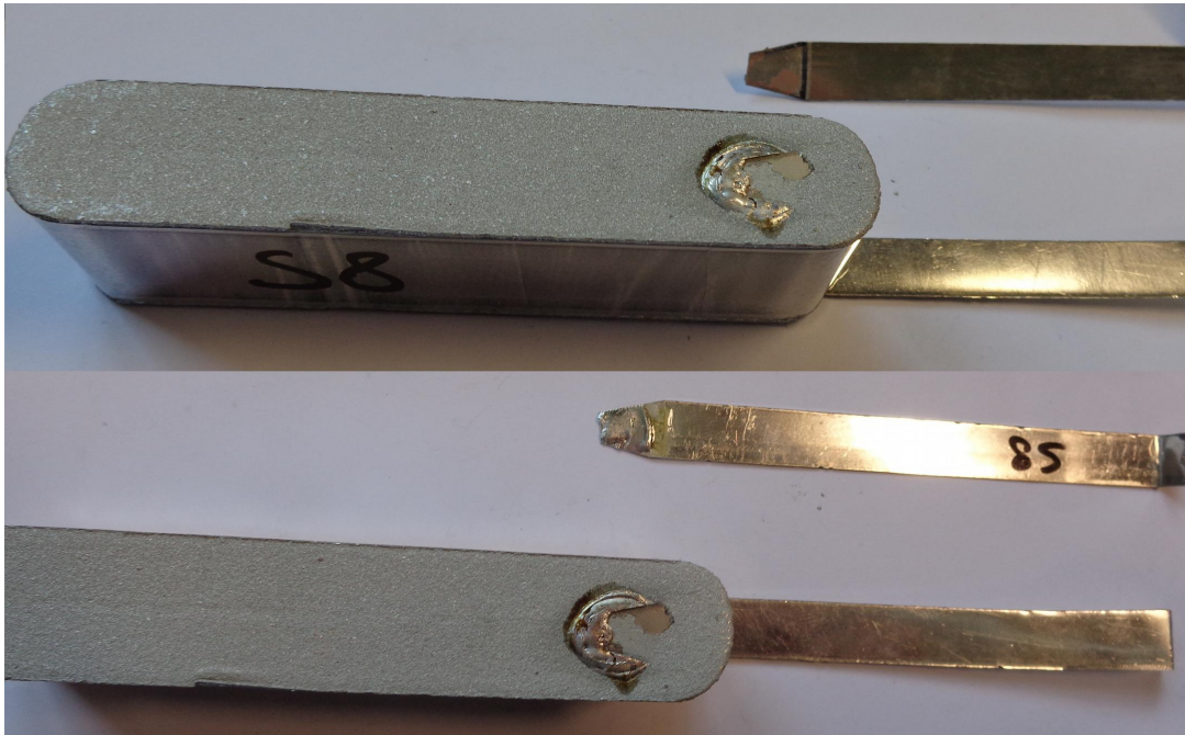
Figura 6.8 Dettaglio della rottura del provino 8.
