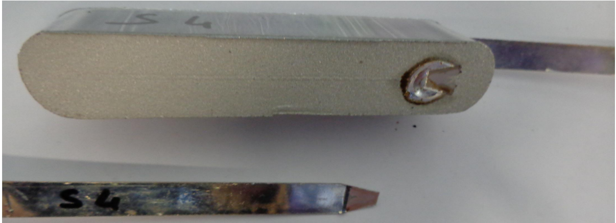
Figura 6.4 Dettaglio della rottura del provino 4.
