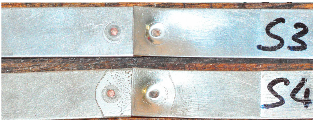
Figura 4.5 Dettaglio delle zone di rotture dei due provini.
