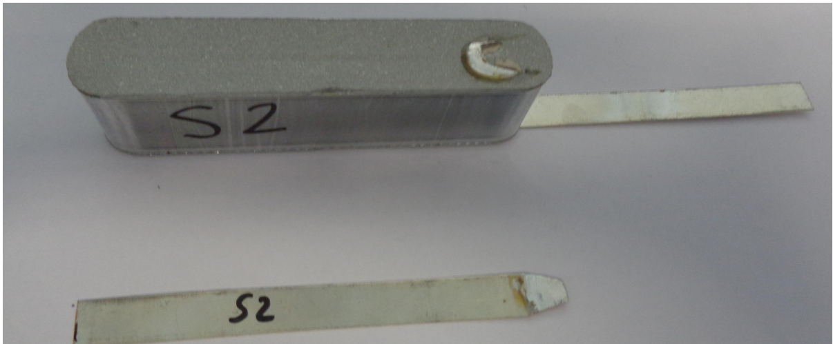
Figura 6.2 Dettaglio della rottura del provino 2.
