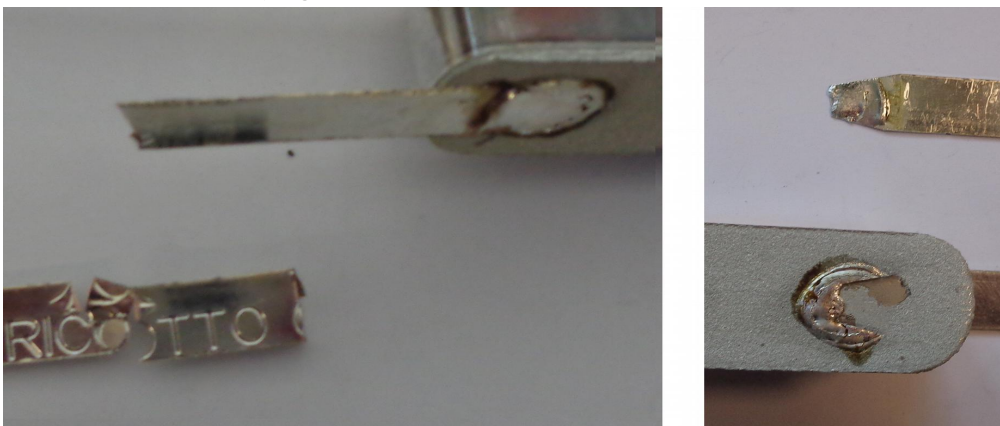
Figura 6.10 Rottura di tipo 1 (sinistra) e rottura di tipo 2 (destra).
