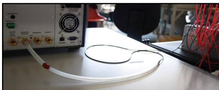
Figura 4.9 Particolare del collegamento pneumatico tra calibratore e scanner di pressione
