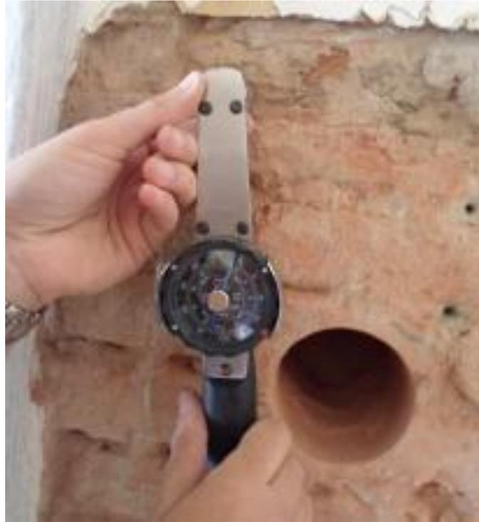
**Figura 37:** Chiave dinamometrica per prova X-drill
