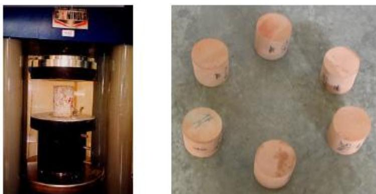
**Figura 39:** Prova di compressione, macchina e provini
