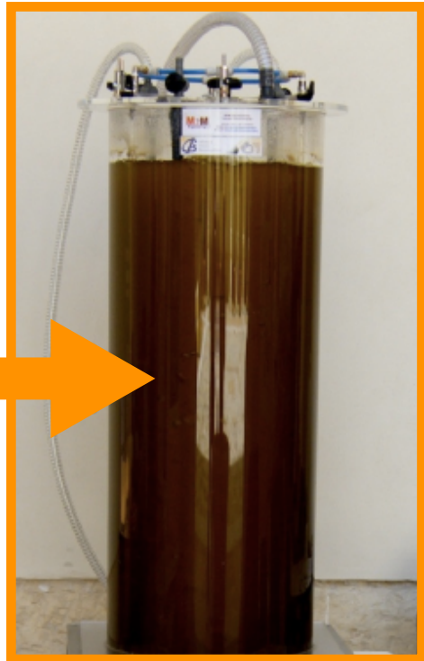
Figura 50 - Fotobioreattore per coltivazione di biomassa algale
