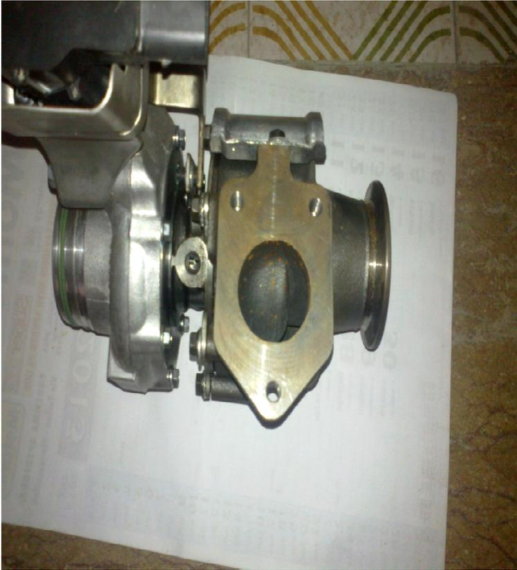
**Figura 8: gruppo turbocompressore BMW vista ingresso turbina.**
