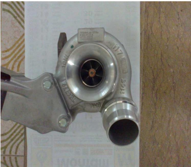
**Figura 9: gruppo turbocompressore BMW; vista ingresso aspirazione e uscita compressore.**
