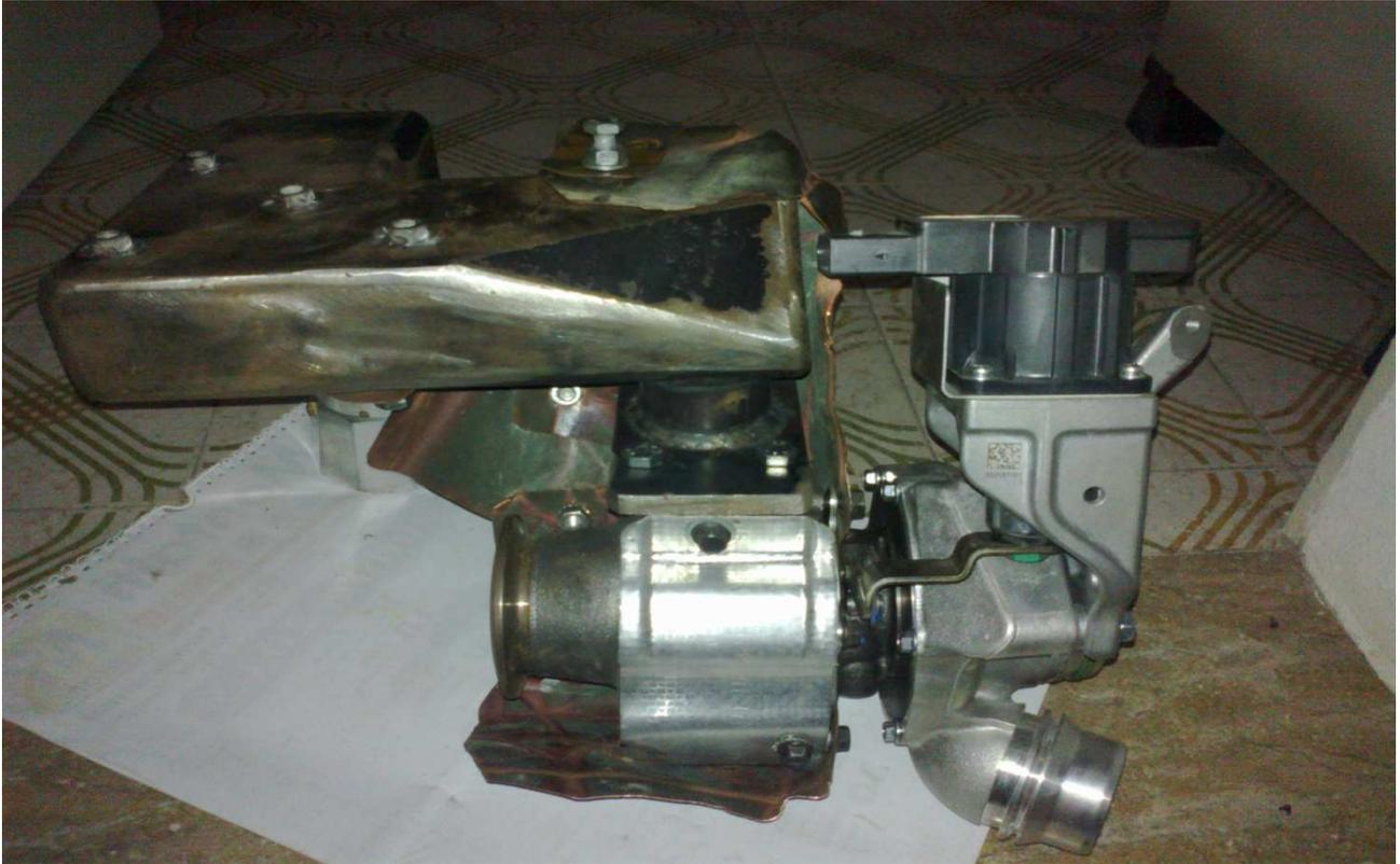
**Figura 3: particolare collegato al gruppo della sovralimentazione con protezioni. Si nota lo “sbocco” eseguito per applicare il connettore alla turbina.**
