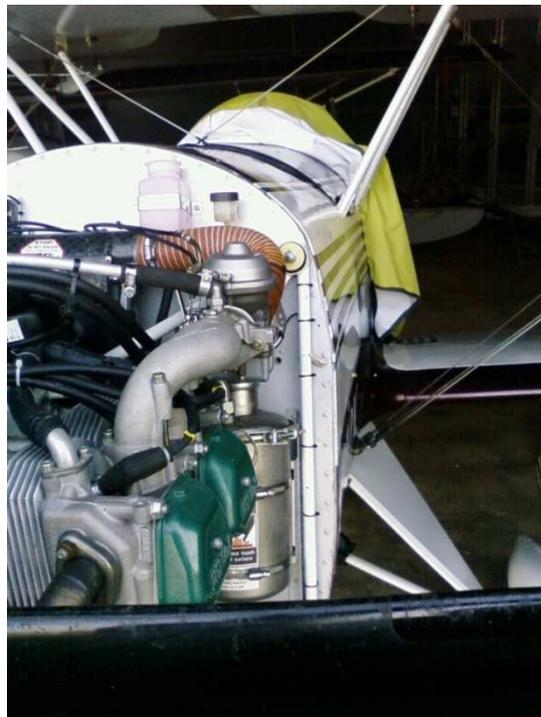
**Figura 6 foto della paratia parafiamma dell'Enjoy e dello schema di fissaggio del castello motore**
