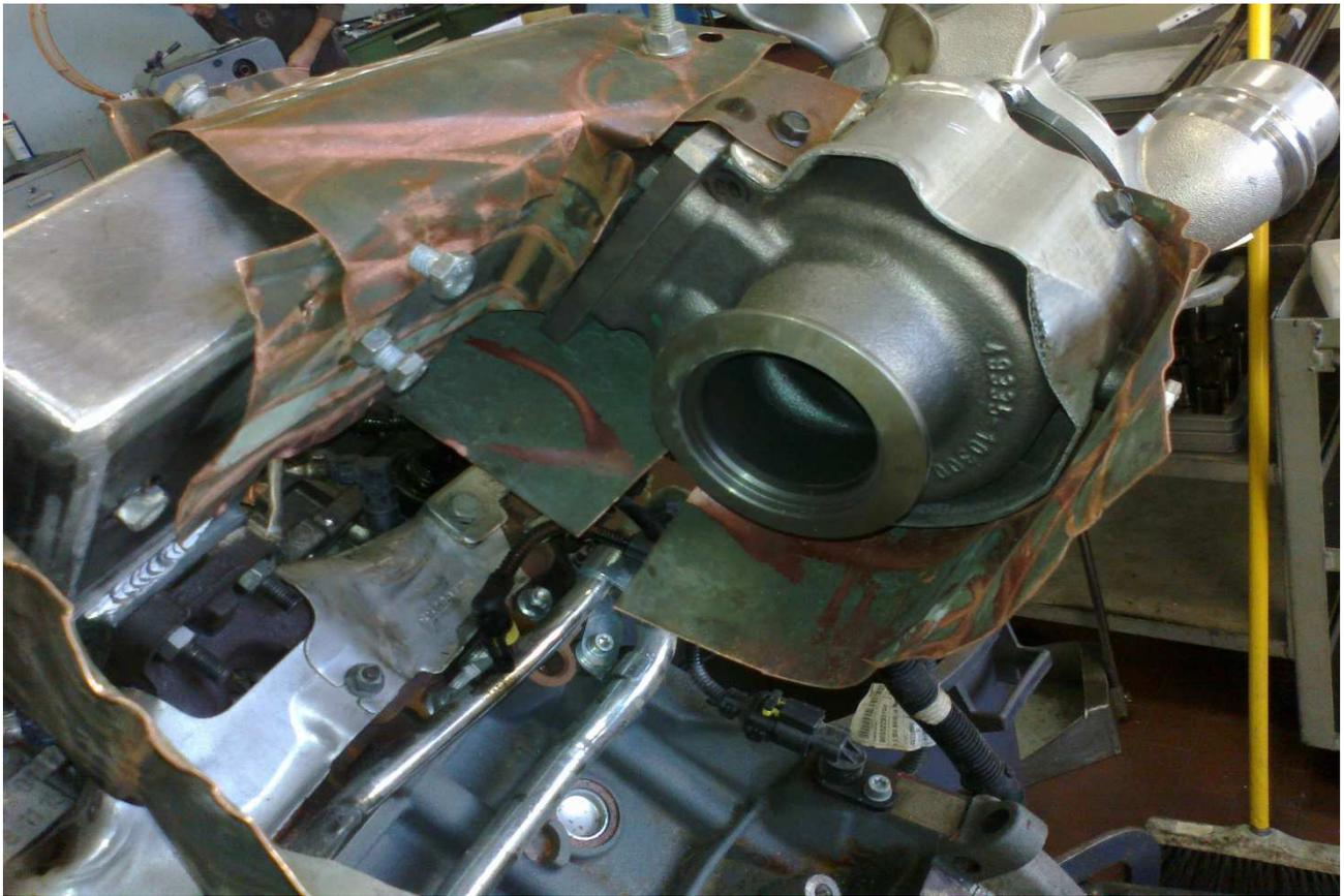
**Figura 1: protezione gruppo turbocompressore.**
