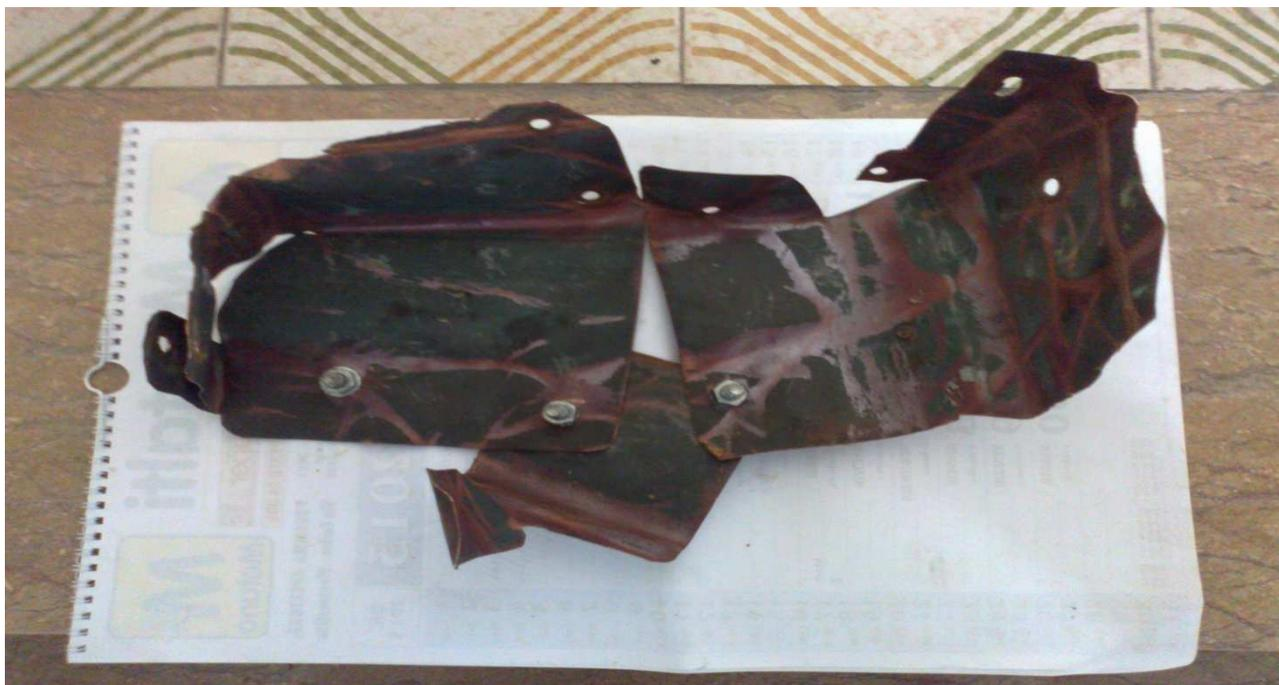
**Figura 2: lamierini che proteggono il gruppo turbocompressore.**
