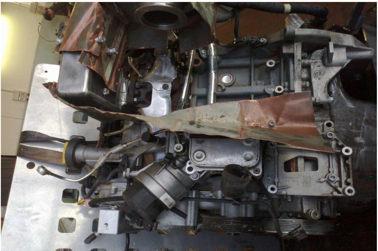
**Figura 2: protezione zone limitrofe unità motrice.**
