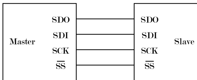
Figura 3.1: Connessione SPI tra master ed un solo slave
