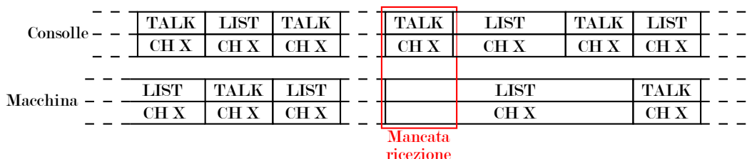
Figura 3.18: Esempio di perdita di un pacchetto
