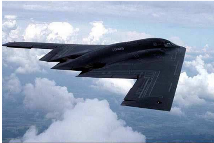
Figura 7. L'aeroplano Stealth, costituito da componenti strutturali in materiale composito in fibra di carbonio; in particolar modo le ali.
