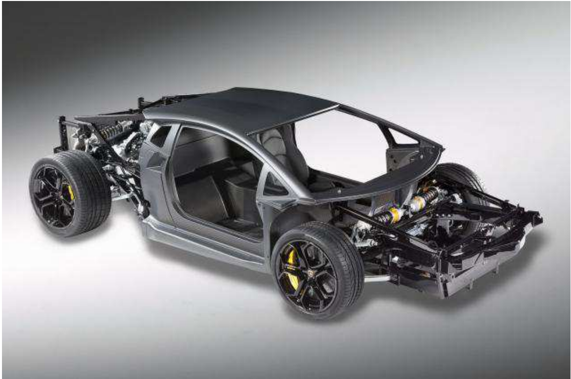
Figura 8. Lamborghini Aventador: scocca in fibra di carbonio
