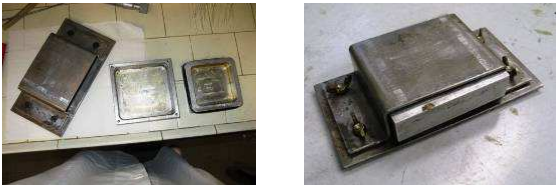
Figura 57: Reattore grande “batch-stampo” utilizzato nella preparazione degli espansi nel primo step
