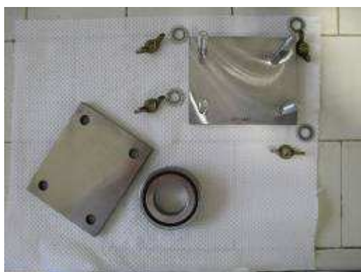
Figura 56: Reattore piccolo “batch-stampo” utilizzato nella preparazione degli espansi nel primo step
