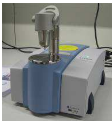
Figura 61: ATR Platinum Bruker Alpha e andamento dell'onda evanescente
