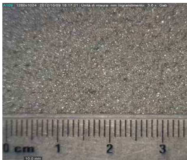
Figura 36: Superficie di un campione visualizzata mediante microscopio digitale (5X).
