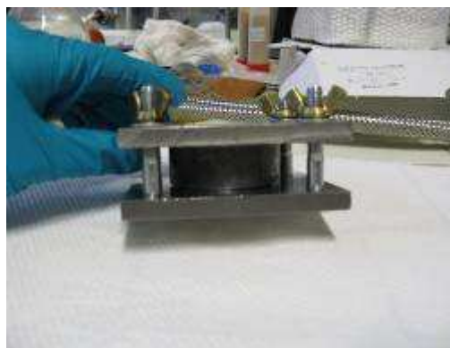
Figura 56: Reattore piccolo “batch-stampo” utilizzato nella preparazione degli espansi nel primo step
