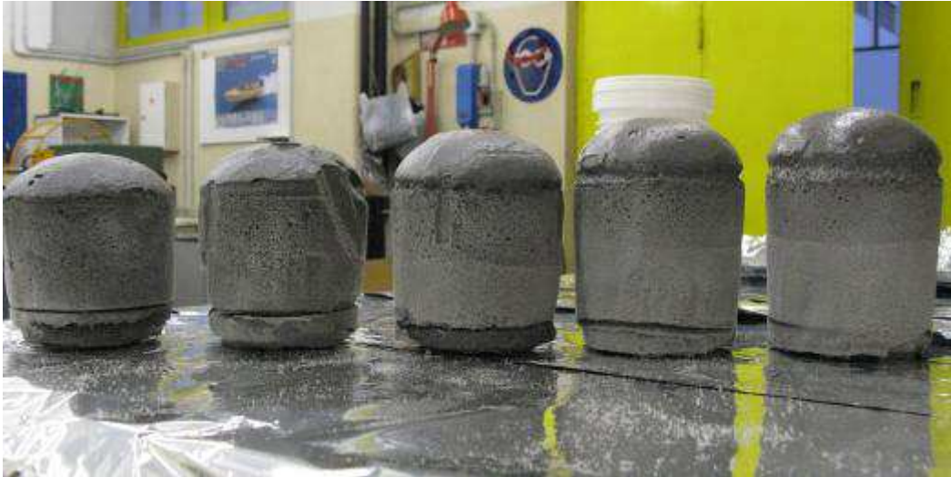
Figura 43: Espansione crescente dei prodotti con poliolo \beta all'aumentare del contenuto di GO (bianco, 0,002, 0,004, 0,009 e 0,013 wt%)
