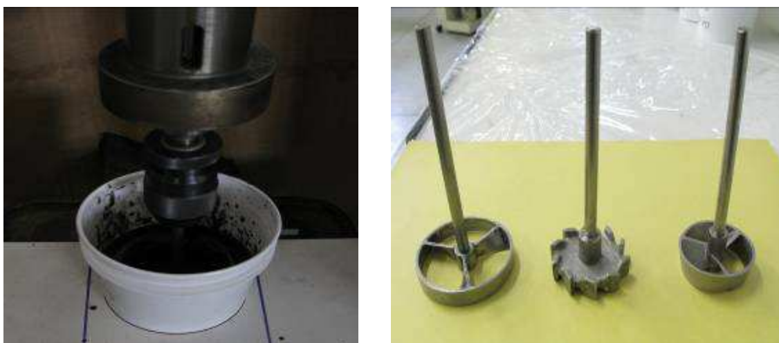
Figura 59: A sinistra miscelazione con trapano a colonna; a destra differenti tipologie di giranti
