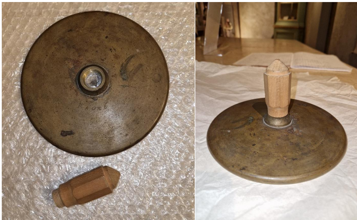
Fig. 30: la mola di 4 palmi e 6 once fine con il suo manico di legno
