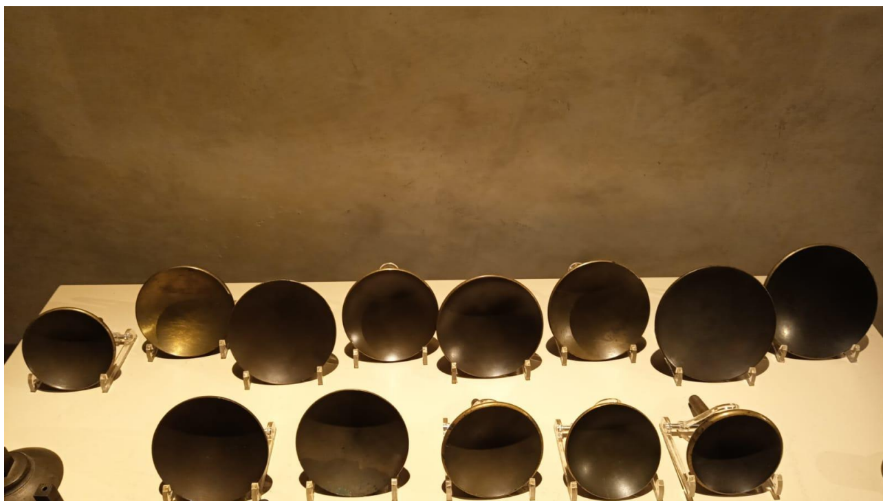
Fig. 28: alcune mole nella Sala della Diottrica, ruotate per rendere visibile il lato sferico da utilizzare nella lavorazione
