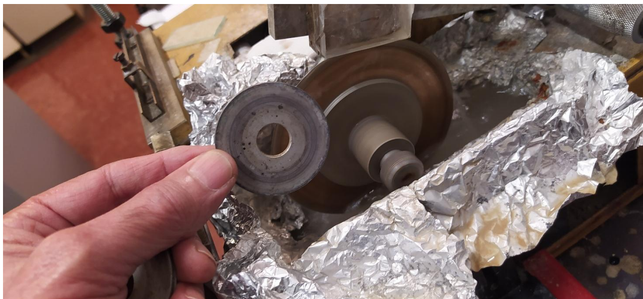
Fig. 42: sponda per lama per tagliare il vetro in un tornio, dall'Istituto Nazionale di Ottica.
