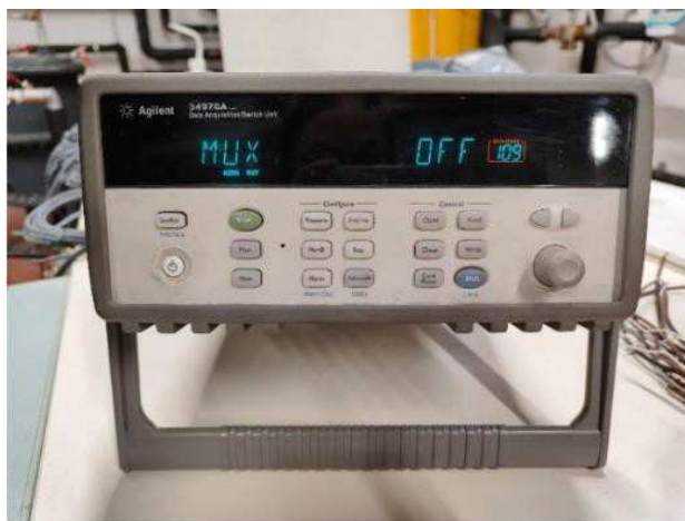
Figura 57. Sistema di acquisizione Agilent 34970A
