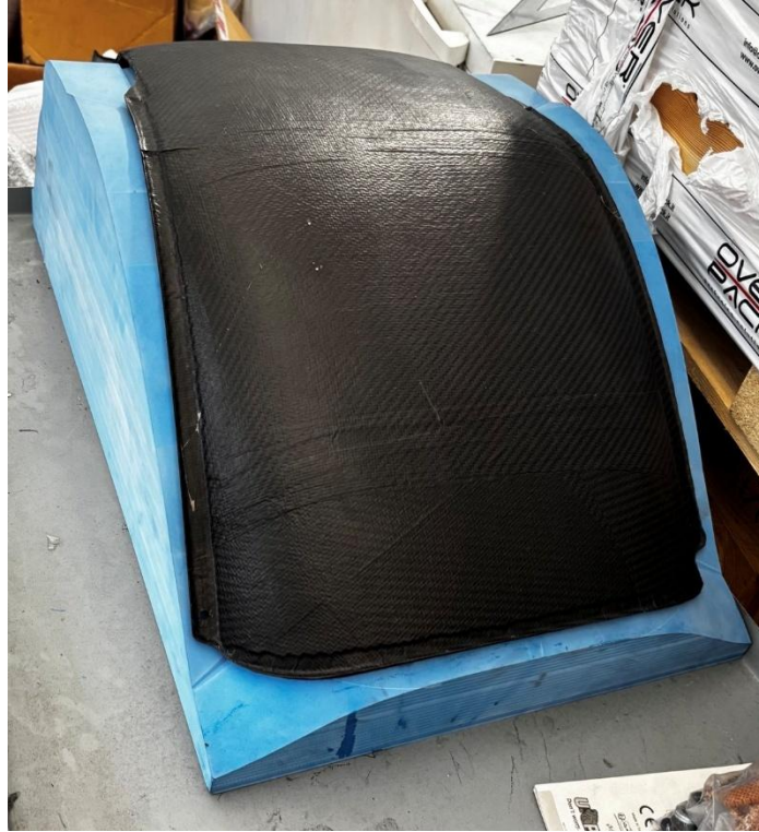
Figura 29 Sedile curato posizionato sopra il suo stampo
