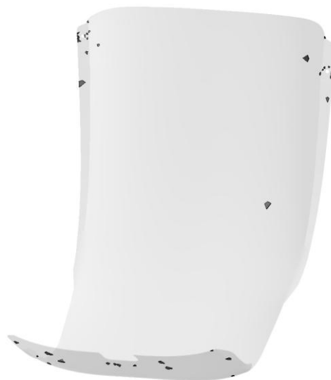
Figura 52 Elementi con uno Jacobian ration minore di 0.5
