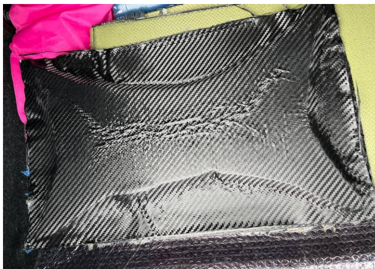
Figura 27 Esempio di core crashato
