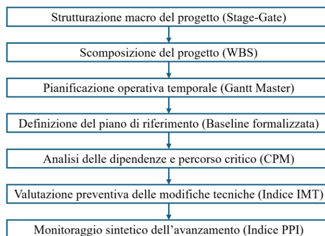
Figura 4.6: Struttura integrata degli strumenti di project management nel modello proposto
