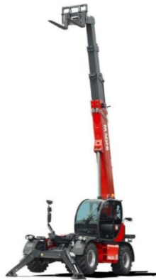
Figura 2.2.2.1: TH6.20 sollevatore telescopico fisso
