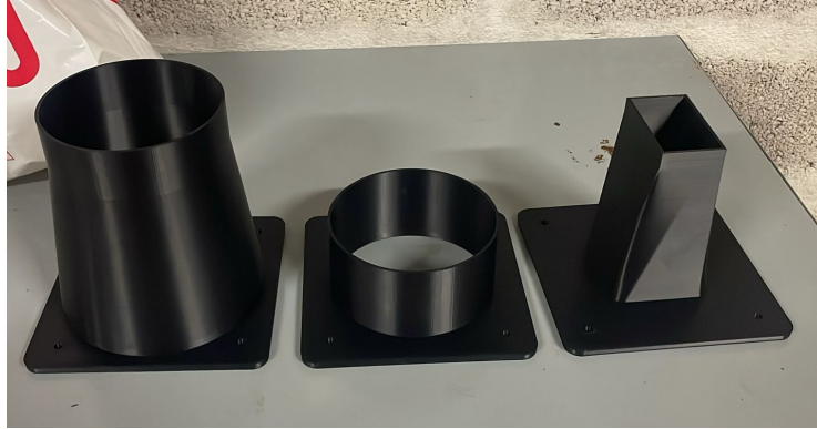
Figura 3.18: Componenti stampati in 3D: innesti e diffusore.
