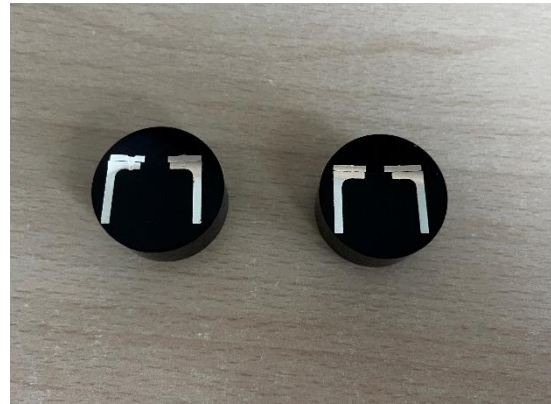
Figura 2.2.2: A sinistra un provino inserito all'interno della macchina resinatrice, a destra due esempi di provini dopo la fase di lucidatura
