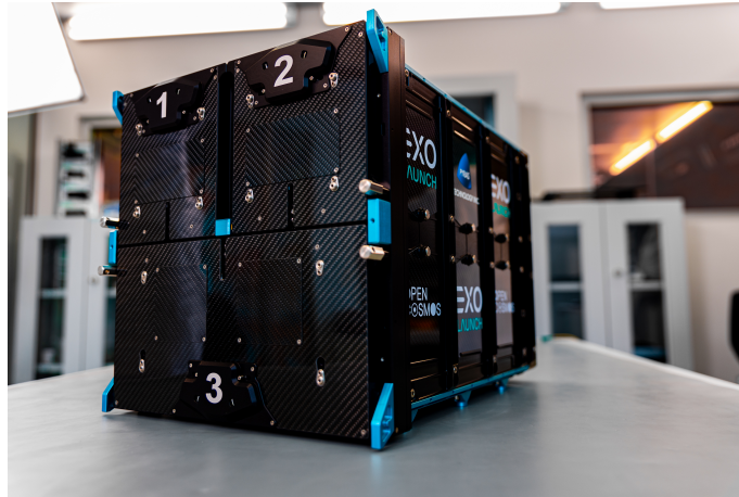
Figura 1.5: Il CubeSat ESA \Phi -Sat-2 integrato e pronto per il lancio. Si tratta di un satellite di tipo 6U, con dimensioni 22 \times 10 \times 33 cm e massa al lancio di circa 9 kg (Crediti: Open Cosmos).
