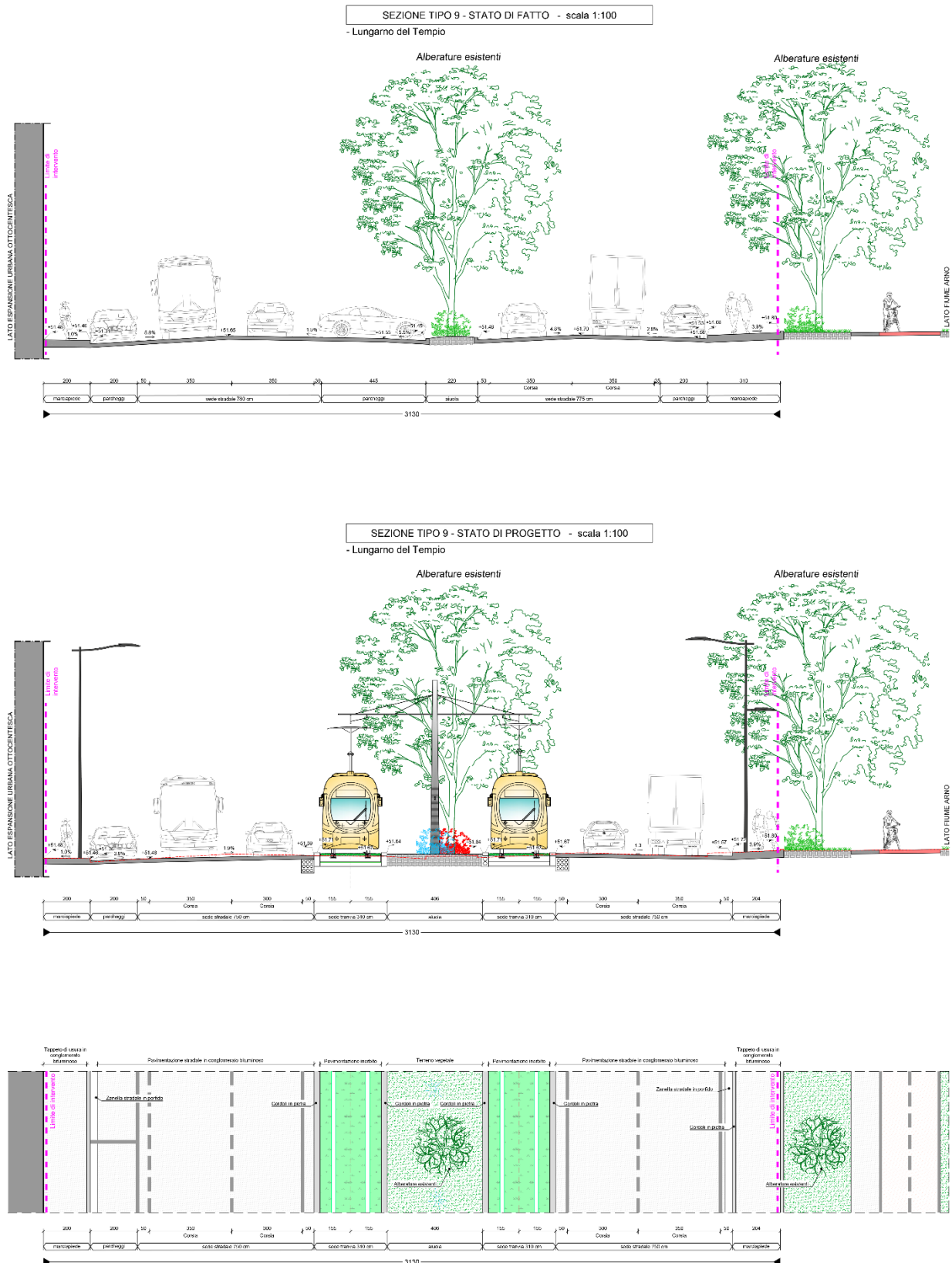
Fig. 25 Sezione trasversale fuori scala dello stato di fatto e dello stato di progetto di Lungarno del Tempio - Estratto da elaborato 3217IX10115PE_0B_S5 del Progetto Esecutivo
