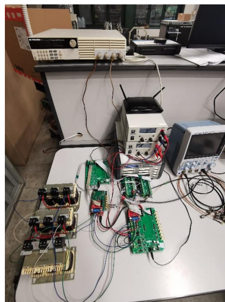
Figura 89: Architettura PHIL implementata in laboratorio
