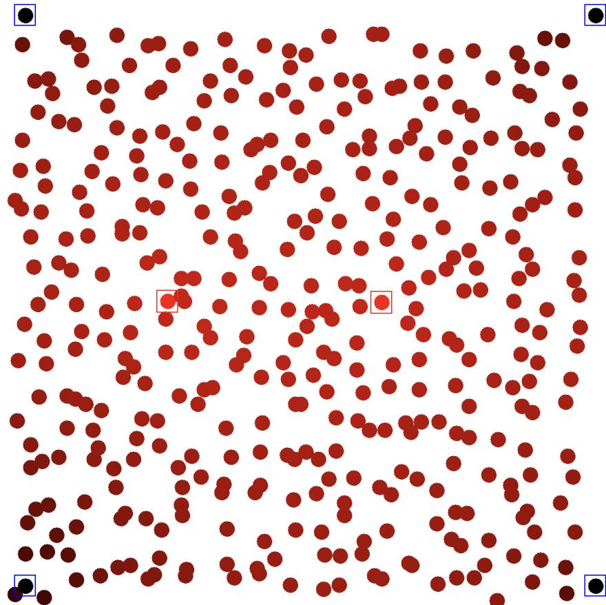
Figura 4.4: Simulazione dell'esperimento in listing 4.8. I dispositivi che agiscono come sorgenti di calore sono evidenziati da un rettangolo rosso, mentre quelli che agiscono come sorgenti di freddo sono evidenziati da un rettangolo blu. Il colore dei dispositivi rappresenta la propria temperatura, con una scala che va dal nero (freddo) al rosso (caldo).
