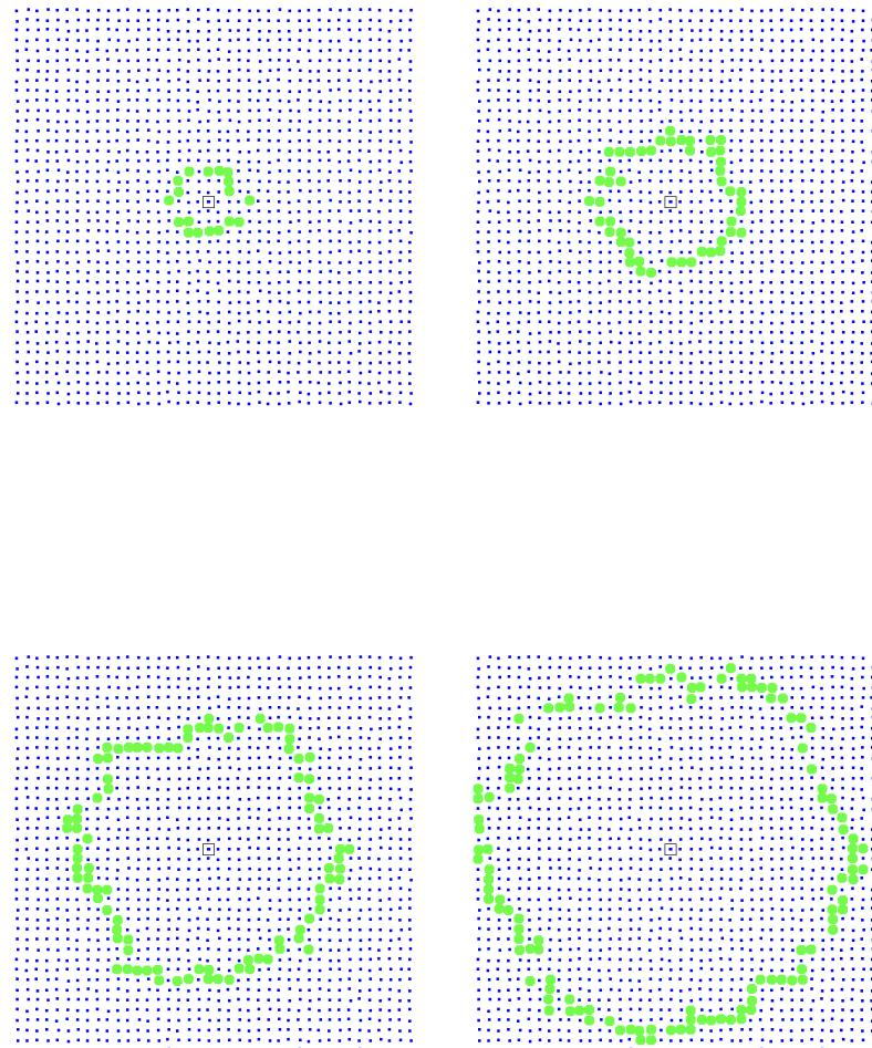
Figura 4.3: Simulazione dell'esperimento in listing 4.6. I dispositivi lungo l'anello sono colorati in verde, mentre gli altri sono colorati in blu. La simulazione è mostrata in quattro istanti temporali distinti, evidenziando il movimento dell'anello nel tempo.
