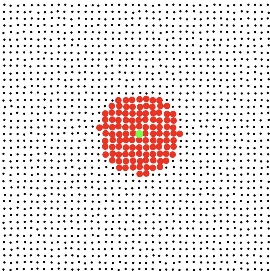
Figura 4.2: Simulazione dell'esperimento in listing 4.4. Il centro o è evidenziato in verde, i dispositivi all'interno del cerchio sono colorati in rosso, mentre i dispositivi esterni al cerchio sono rappresentati in nero.
