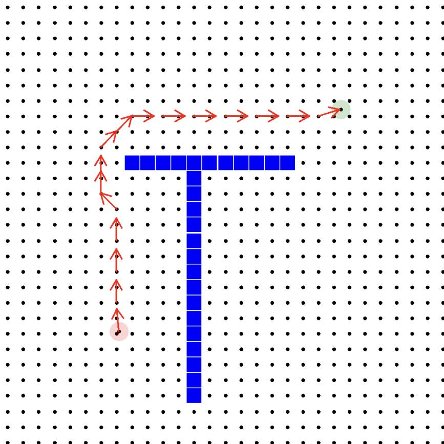
Figura 4.7: Simulazione dell'esperimento in listing 4.20. La sorgente è evidenziata in rosso mentre la destinazione in verde. Gli ostacoli sono rappresentati attraverso quadrati blu. I dispositivi che appartengono all'albero puntano verso il prossimo nodo del cammino, formando un collegamento che unisce sorgente e destinazione.
