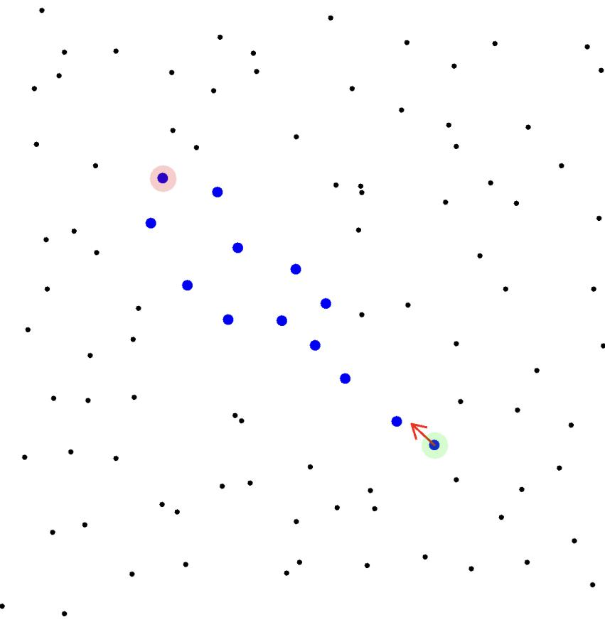
Figura 4.8: Simulazione dell'esperimento in listing 4.22. Il dispositivo target è evidenziato in rosso, mentre la destinazione in verde. I nodi che compongono il canale di comunicazione sono colorati in blu. La destinazione segue il target sfruttando le informazioni propagate lungo il canale.
