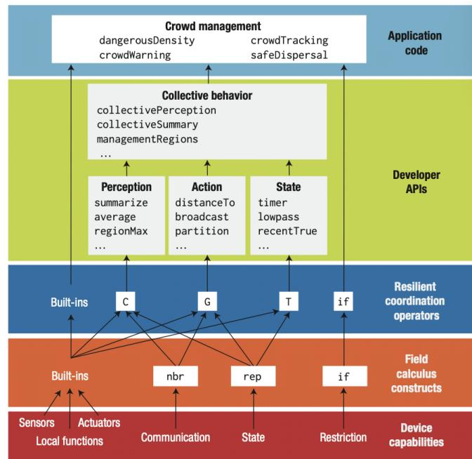
Figura 1.1: Architettura a livelli della programmazione aggregata [BPV15]. Le capacità del dispositivo sono sfruttate per implementare i costrutti di FC, che a loro volta costituiscono la base per la creazione di un limitato numero di operatori aggregati di cui si può provare la resilienza. Tali costrutti sono così generali da poter essere utilizzati per costruire librerie di alto livello per la programmazione aggregata.
