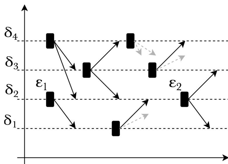
Figura 1.2: Modello di esecuzione di XC: il dispositivo  $\delta_i$  esegue il programma XC nei round  $\varepsilon_n$  e invia i messaggi ai vicini al termine di ciascuno [ACD<sup>+</sup>24].
