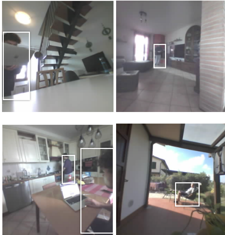
Figura 4.18: Person detection su ESP32-S3 con i quattro modelli ottenuti. Dall'alto a sinistra procedendo in senso antiorario: YOLOv11micro_DA_64/96/128/160
