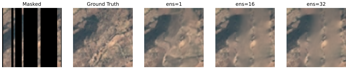
Figura 5.3: Risultati di inpainting su un'immagine del test set al variare del numero di predizioni mediate nell'ensemble: 1, 16 e 32.
