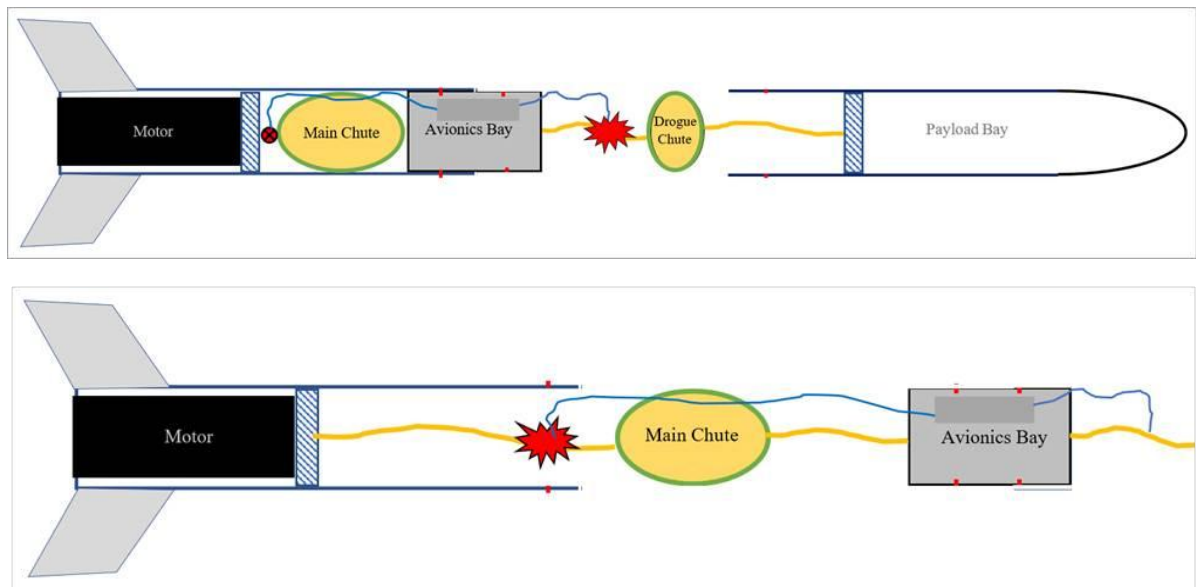
Figura 26: Sequenza di apertura del drogue e main del modello che sfrutta delle cariche di polvere e delle paratie fisse
