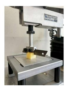
Figura 18- Test di taglio con Texture Analyser.
