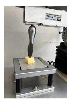
Figura 19- Test di penetrazione con Texture Analyser.
