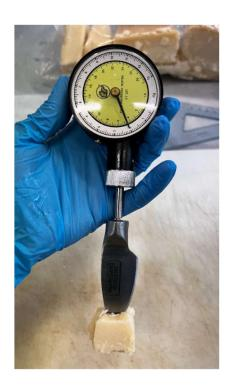
Figura 21-Test di penetrazione con Penetrometro.
