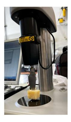
Figura 20- Test di penetrazione di Fruit texture Analyser.
