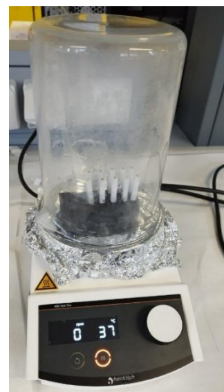
Figura 29 – setup per incubazione dell'anticorpo a 37 °C
