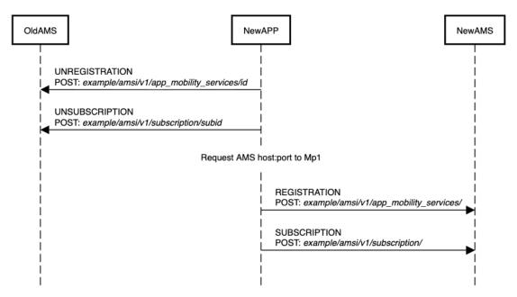
Figura 23 - Diagramma di sequenza Migrazione applicazioni con AMS nel caso federato
