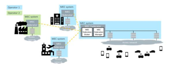
Figura 14 - Cooperazione MEC Multioperatore [3]
