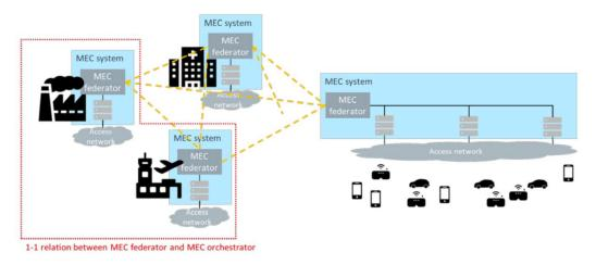
Figura 11 - MEF gestiti con architettura P2P [3]
