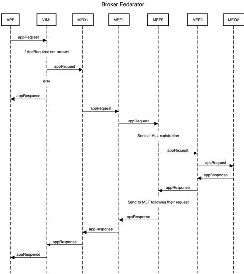
Figura 24 - Diagramma di sequenza Richiesta di un'applicazione nel caso federato
