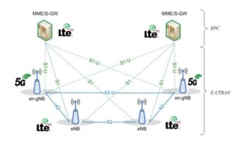
Figura 4 - Architettura Non-Stand-Alone [1]
