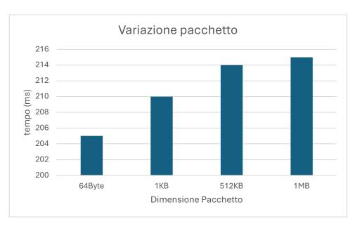
Figura 37 - Tempo di trasferimento stato al variare della dimensione del pacchetto
