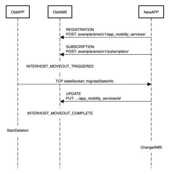
Figura 21 - Diagramma di sequenza Migrazione applicazione con AMS nel caso federato
