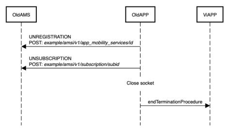
Figura 22 - Diagramma di sequenza Migrazione app con AMS nel caso federato
