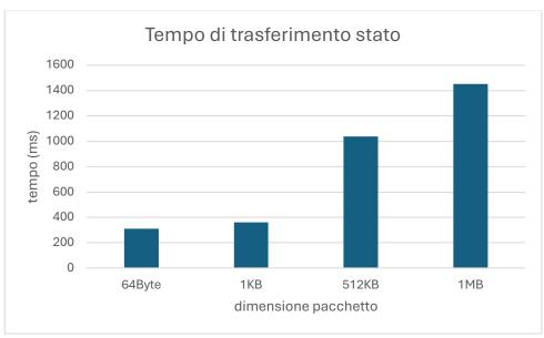
Figura 40 - Tempo di trasferimento stato al variare della dimensione del pacchetto
