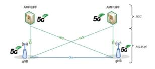
Figura 5 - Architettura Stand-Alone [1]
