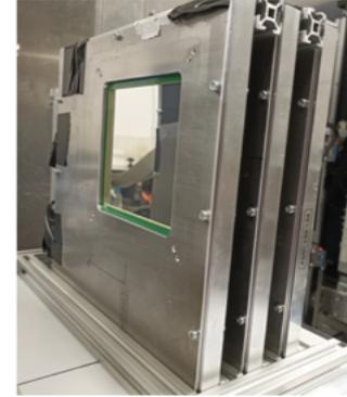
**Figura 2.8:** Nella figura di sinistra è riportato lo schema di principio del rivelatore a microstrip in silicio (MSD), mentre a destra è mostrata la fotografia di un modulo reale del Micro Strip Detector
