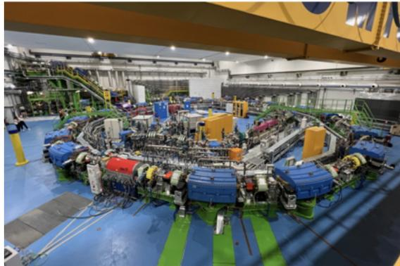
**Figura 1.3:** Il sincrotrone del CNAO (Pavia), utilizzato per accelerare protoni e ioni carbonio per i trattamenti clinici di adroterapia [5].
