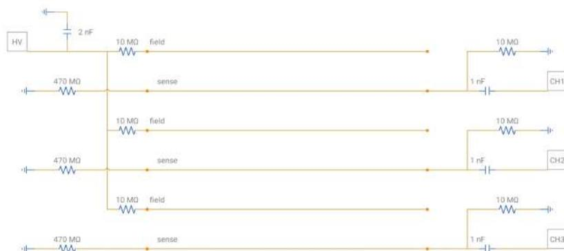
Figura 3.9: Schema esemplificativo del circuito di una scheda in pcb dei primi sei fili della camera, dove i punti indicano le saldature del filo e CH1, CH2 e CH3 rappresentano l'uscita del segnale
