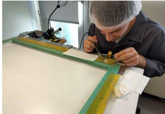
(b) Saldatura del filo di sense.
