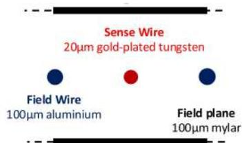
Figura 2.2: Rappresentazione schematica della specifica cella utilizzata nella camera costruita, dove il catodo è chiamato field dato che forma il campo elettrico, mentre l’anodo è chiamato sense perché è dove si raccoglie il segnale.
