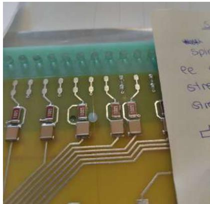
Figura 3.14: Posizionamento del filo di field.
