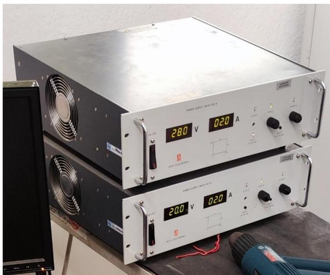
*Fig. 12 Coppia di alimentatori utilizzati nel banco Selcom.*
