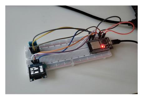
Figura 5.3: Prototipo con esp32, sensore e display
