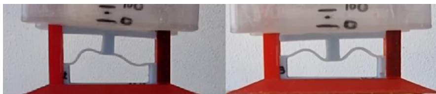
Figura 31 – Collasso asimmetrico (a sinistra) e simmetrico (a destra)
