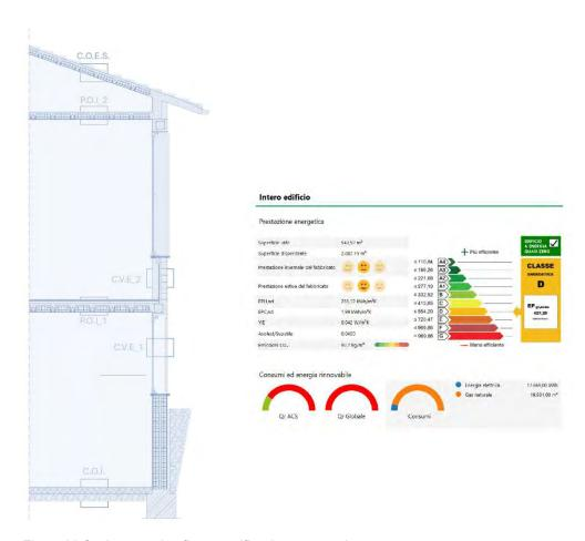
Figura 23 Sezione stratigrafica e certificazione energetica
