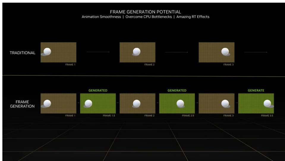
Figura 5.2: Esempio di frame generati tramite Frame Generation.
