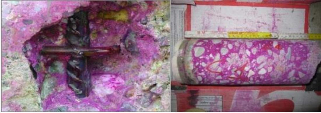
*Figura 7 Profondità di carbonatazione*
