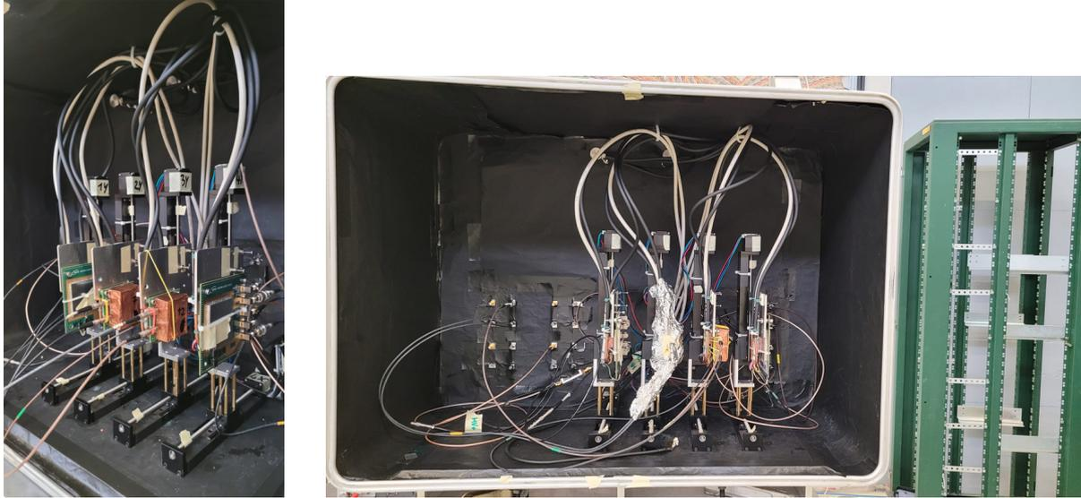
Figura 3.1: Fulcro dell'apparato sperimentale: i due SiPM al centro, i due LGAD alle estremità.
