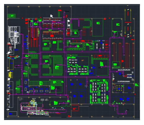
Fig. 5.1: rappresentazione dei percorsi inerenti ai flussi misurati (color magenta).
