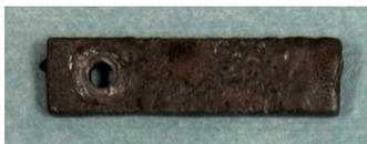
*Figura 4.5 - Provino dopo l'esposizione in Pb liquido in condizioni statiche.*
