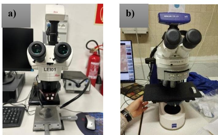
*Figura 4.14 - Microscopio ottico (a) LEICA M80; (b) Zeiss Axiocam 208 color.*
