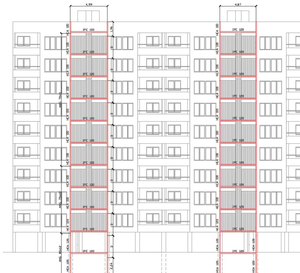
Fig. 75: Prospetto ovest dell'edificio con elementi dell'esoscheletro in rosso.
