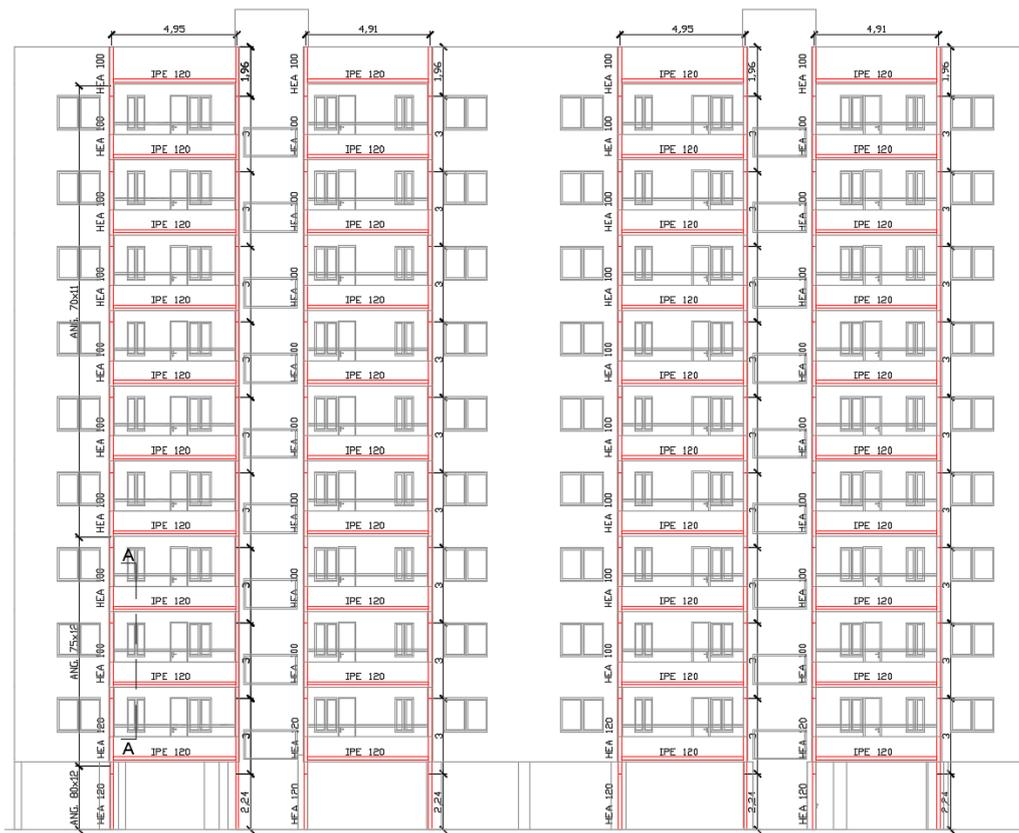
Fig. 74: Prospetto est dell'edificio con elementi dell'esoscheletro in rosso.
