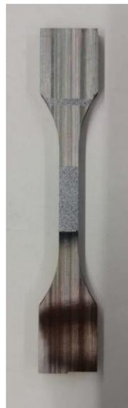
*Figura 3.1* Provino preparato per la prova di trazione
