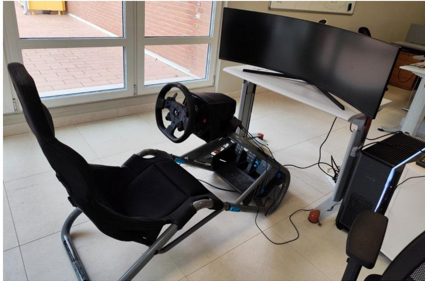
**Figura 4.8:** Postazione con monitor, volante, pedali e sedile di guida
