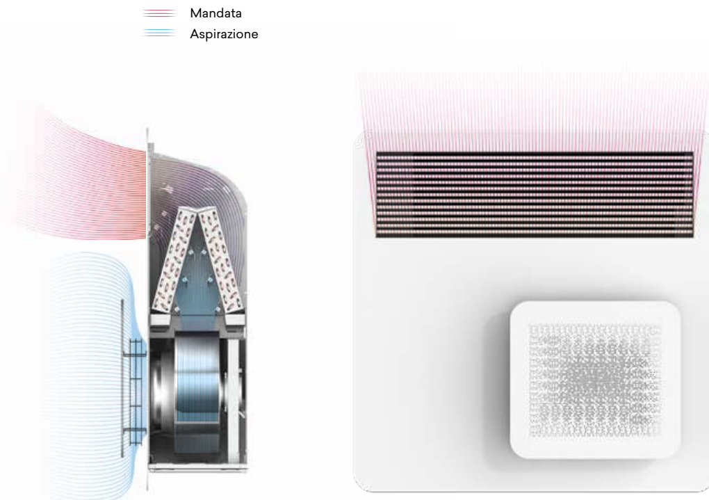
FIGURA 48: Mandata e aspirazione pompa di calore STØNE
