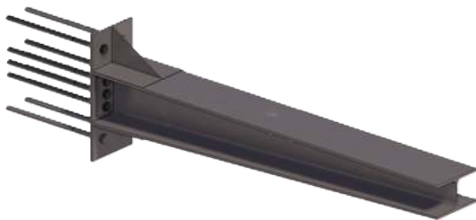
FIGURA 36: Trave HEA 200 rastremata e flangiata completa di fissaggi
