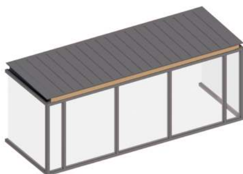
FIGURA 42: Elemento di chiusura in vetro con copertura montata a secco
