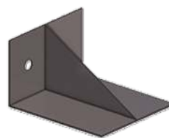
FIGURA 38: Ginocchia di irrigidimento saldate sull'ali
