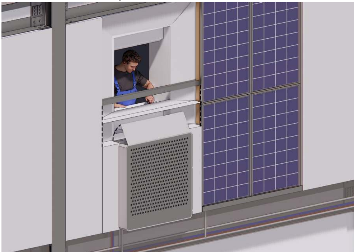
FIGURA 68: Manutenzione ordinaria pompa di calore STØNE
