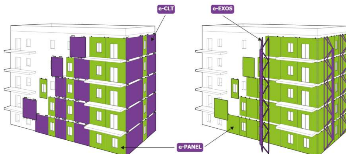
FIGURA 9: E-safe riqualificazione energetica e strutturale (Fonte: www.esafe-buildings.eu )
