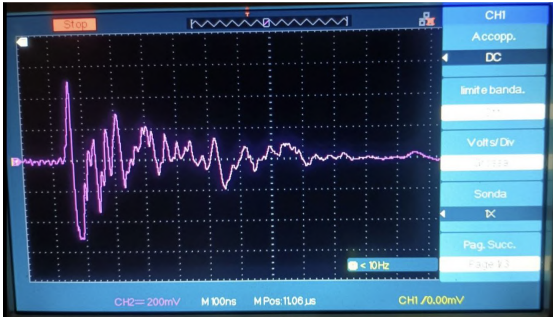
Figura 4.6: Analisi del segnale durante una scarica elettrica.
