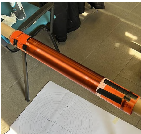
Figura 3.21: Avvolgimento secondario in fase di asciugatura dell'isolante.
