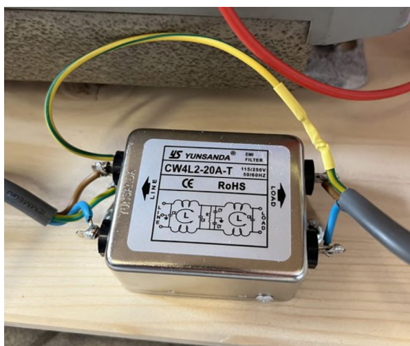
Figura 3.19: Filtro di linea di Sparky montato e collegato
