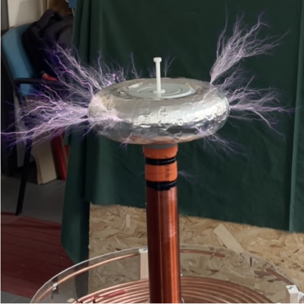
Figura 3.22: Foto a lunga esposizione dei fulmini prodotti senza una punta.
