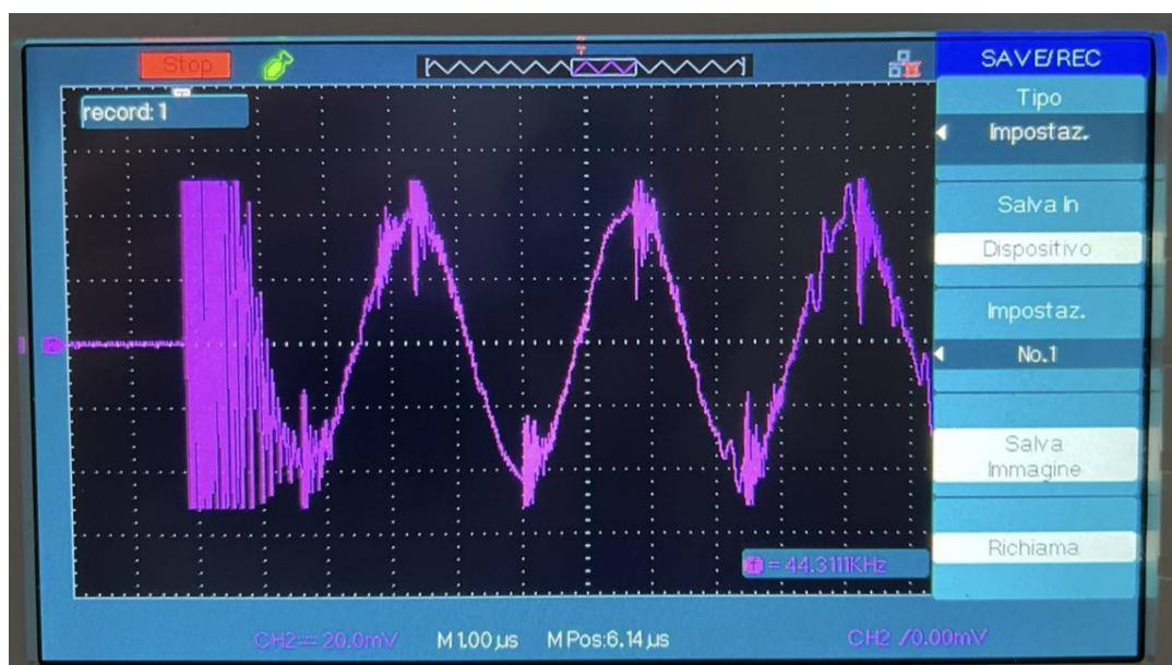
Figura 4.5: Segnale prodotto dalla bobina in funzione.
