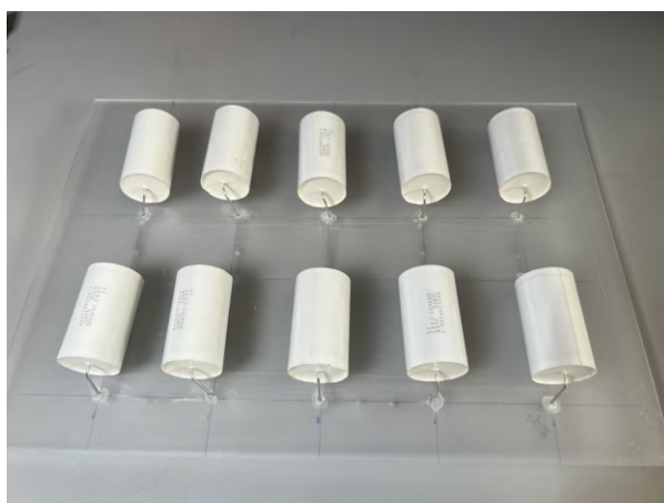
Figura 3.6: Condensatori di Sparky, collegamento in serie.
