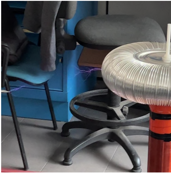
Figura 4.1: Immagine delle scariche prodotte PRIMA del tuning dei due circuiti.
