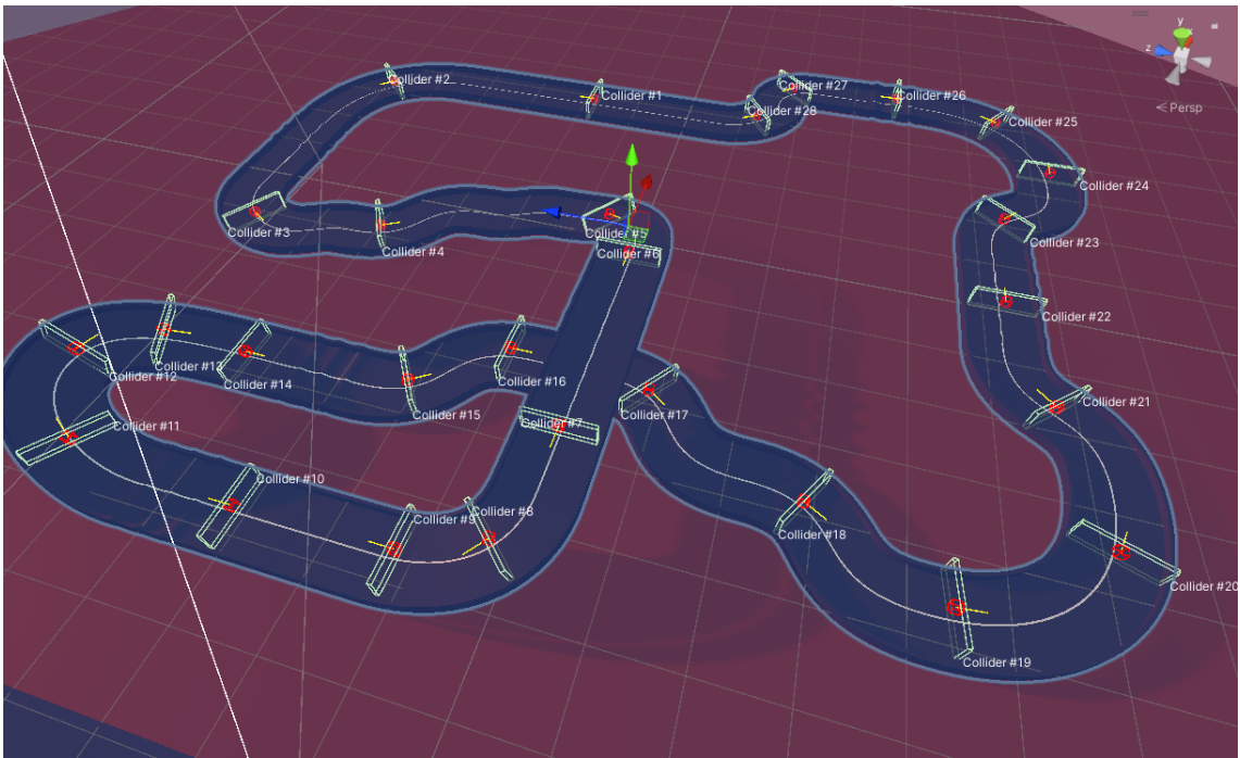
Figura 1.4: Si evidenziano la presenza dei box collider in una delle mappe di gioco utilizzate per l'addestramento.
