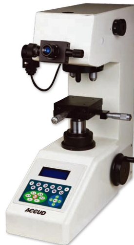
Figura 1.14. Durometro micro-vickers. Immagine estratta da sermacsrl.com
