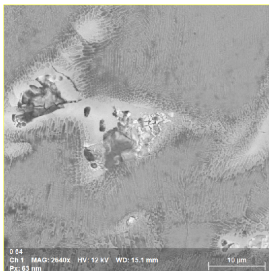
Figura 2.24. Cubetto con 5% di WC-Co. Immagine ottenuta al SEM
