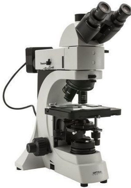
Figura 1.16. Microscopio metallografico. Immagine estratta da geass.com
