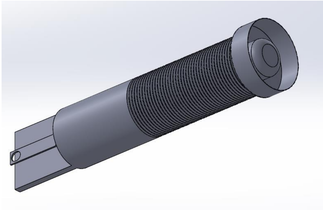
Figura 25: Indicatore led, progettato su Solidworks
