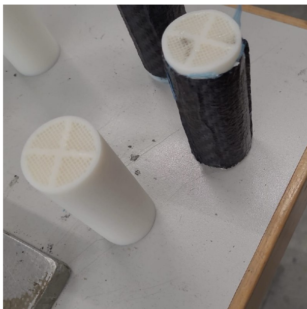
Figura 5.1: Provino non laminato e provino laminato alla fine del ciclo di cura in autoclave.
