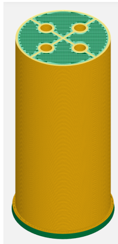
Figura 4.1: Esempio di anima rinforzata, SR-30 in giallo e ABS-P430 in verde.
