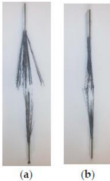
Figura 59: Provini dopo cedimento durante le prove di fatica di (a) compositi ibridi inter-ply (1C-2F-1C-2F-1C) e (b) intra-ply (14 strati, co-tessuto).
