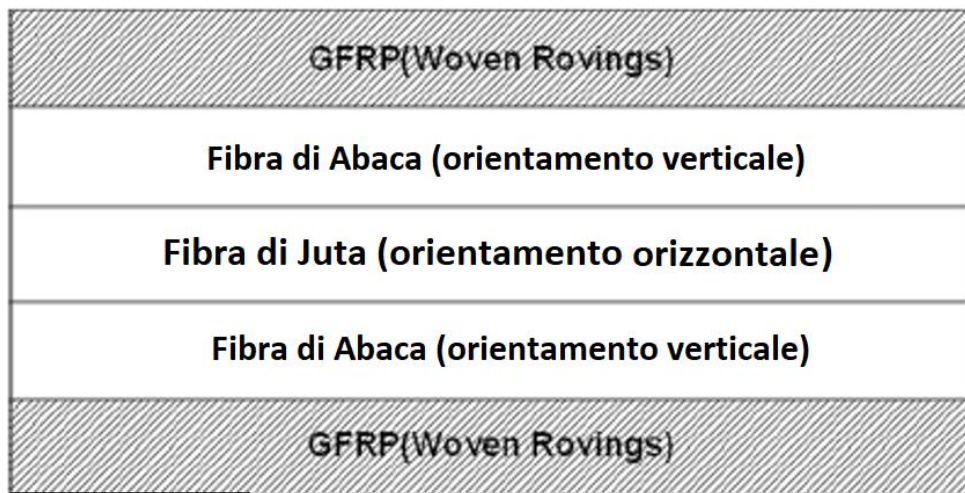
Figura 28: Diagramma schematico della stratificazione dei laminati per provini ibridi GFRP – Abaca – Juta
