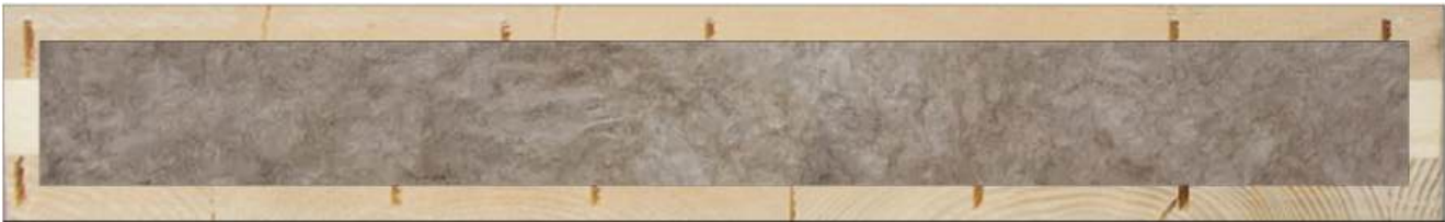
Cassero parete perimetrale con isolamento acustico interno
