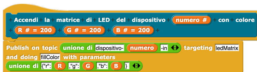
Figura 3.4: Blocco per l'accensione della matrice di LED di un sistema embedded
