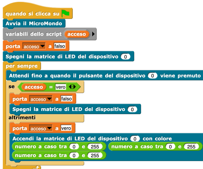
Figura 3.12: Micromondo per il controllo di una matrice di LED tramite un pulsante
