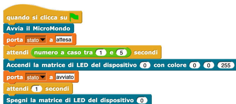
Figura 3.18: Flusso principale del Micromondo per il gioco di reazione
